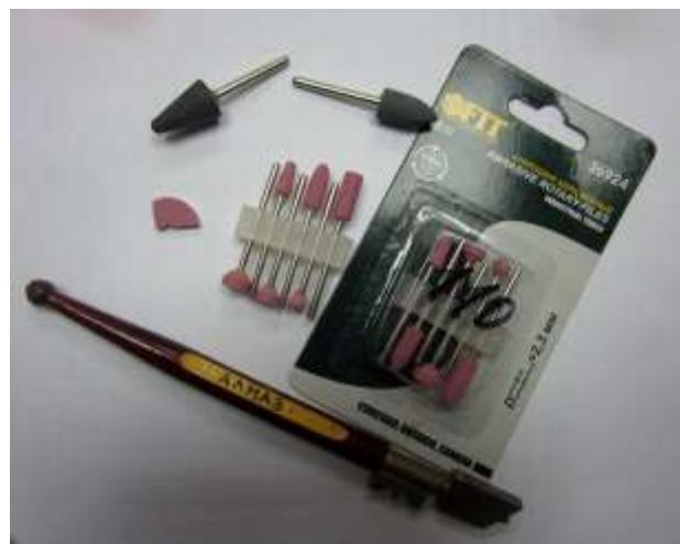
Рис. 12. Шарошки из корунда и алмазный стеклорез
