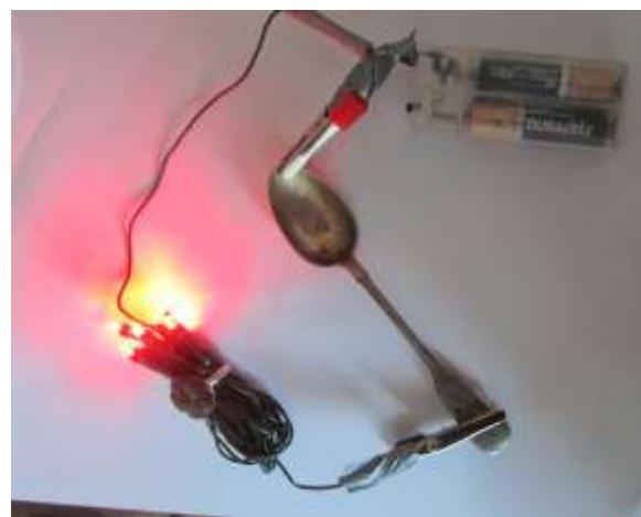
Рис. 16. Простейший самодельный прибор для изучения относительной электропроводности минералов (проверяем работоспособность на серебряной ложке)
